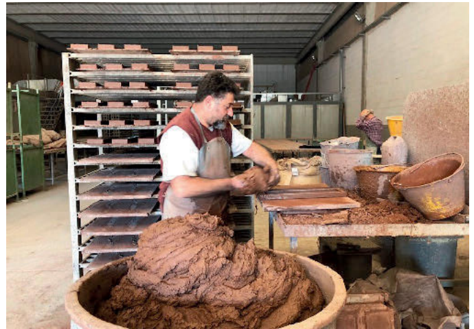
Die Cotto-Spezialisten der lokal ansässigen Manufaktur Manetti fertigten für Casa Morelli 14 000 kleine Ziegelchen von Hand
