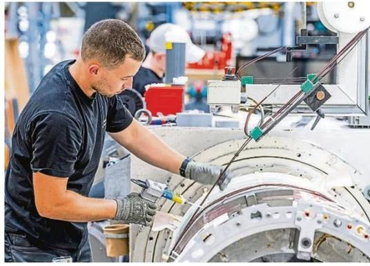
Besser und sparsam: Ein Mann arbeitet bei der Fertigung der Gradientenspule zu einem Magnetresonanztomografie-Gerät in Erlangen.
