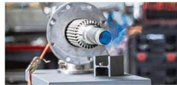
Dieser Brenner kann Wärme aus Erdgas effizienter bereitstellen als herkömmliche Geräte.
